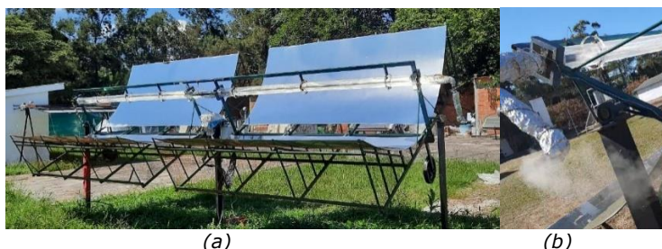
Figura 1: Equipo utilizado para las mediciones y posterior validación del software. (a) Vista orientado en incidencia solar. (b) Salida de vapor desde el absorbedor.
