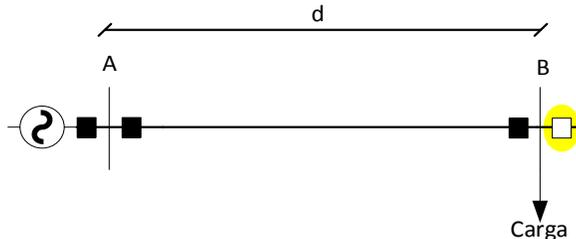
**Figura 1:** LT entre nodos 'A' y 'B', separadas por una distancia eléctrica 'd'.
