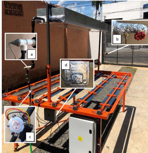
Figura 6: Disposición de sensores. a. Termocupla Max6675, b. Termocupla DS18B20. c. Caudalímetro YSF-401, d. Sensor termohigrómetro DHT22. Todos los sensores son Arduino.
