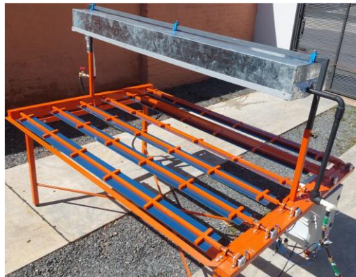
Figura 5: Receptor acoplado a la estructura de concentración solar mediante un pórtico. Se observa la entrada de agua fría y la salida de agua caliente/vapor, como así el gabinete de control de seguimiento solar y toma y adquisición de datos mediante sensores.
